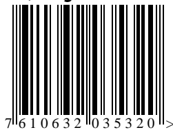
Abbildung 2: GTIN-13, dargestellt in einem EAN-13 Symbol
